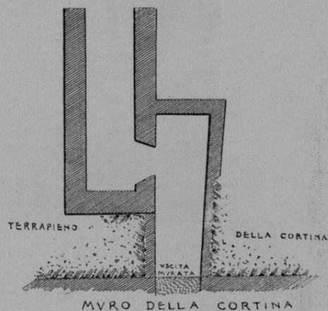
FIG. 305 — PIANTA DEL PORTELLO OCCIDENTALE DELLA FORTEZZA DI RETIMO.
