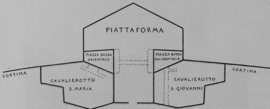
FIG. 263 — CANEA : PIANTA SCHEMATICA DELLA PIATTAFORMA E DEI SUOI DUE CAVALIEROTTI.
