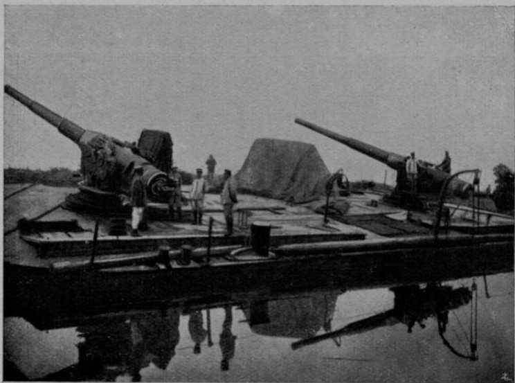
BATTERIA DA 203 DELLA R. MARINA SU PONTONE
