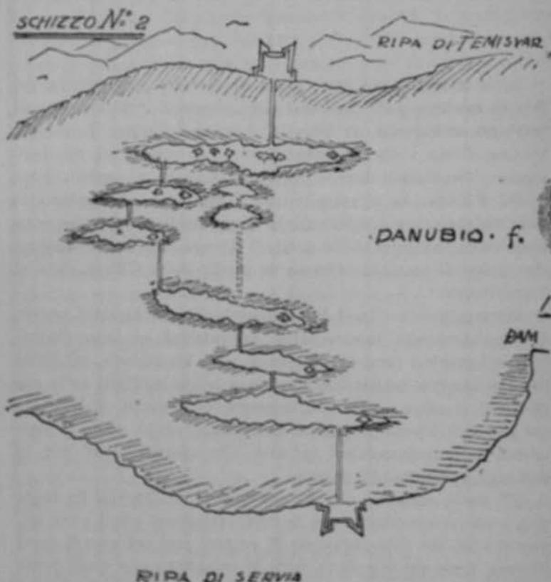
stenti specie sul Danubio e su altri grossi affluenti per farli servire come corpi di sostegno intermedi, onde evitare lunghe tratte con sostegni d'equipaggio soltanto, che non sempre poteva avere a sua disposizione. Un esempio degno di nota di ponte sul Danubio approfittando di isolotti (schizzo N. 2)<sup>1</sup> fu
