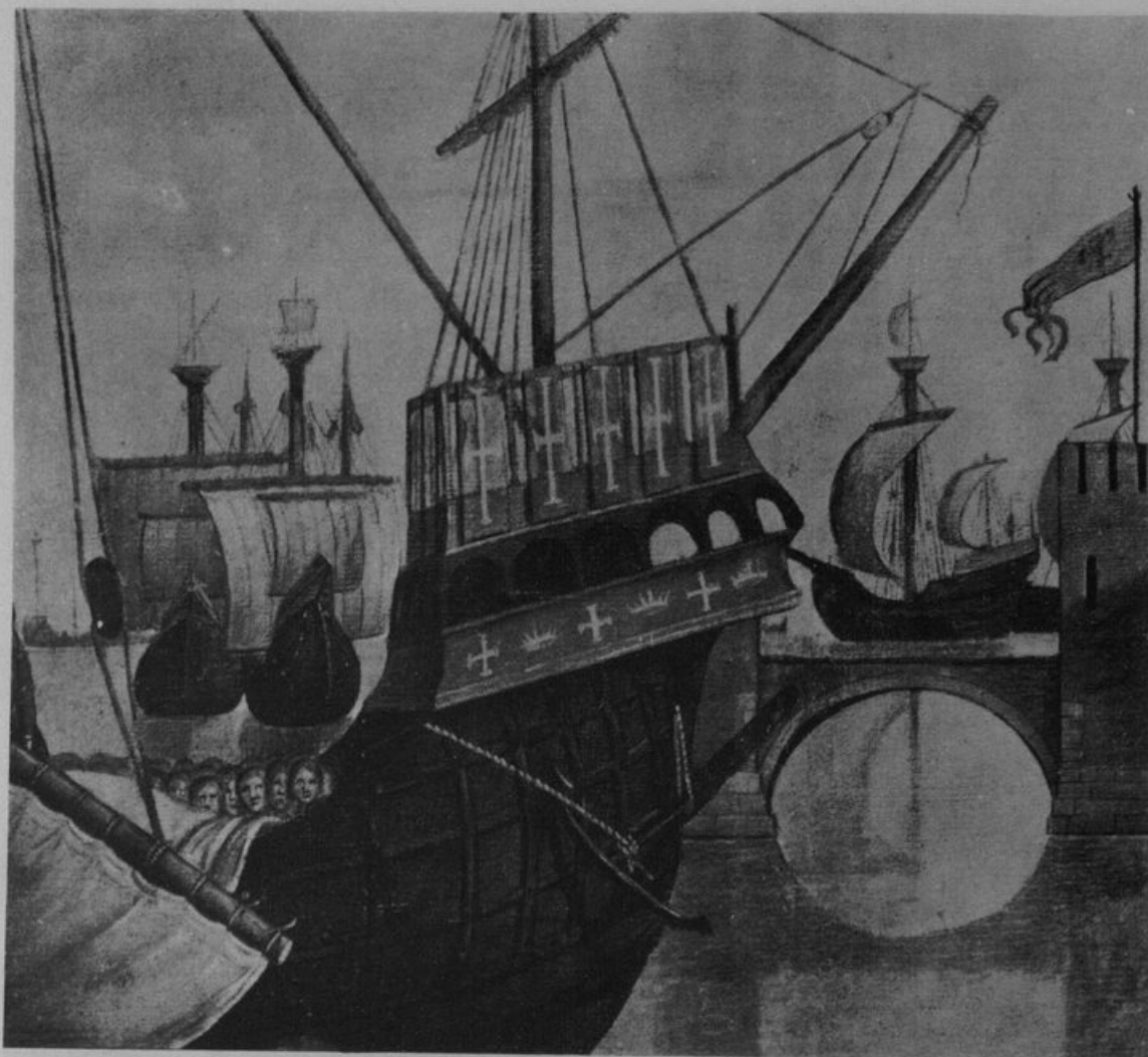
Fig. 134 - Particolari dell'incastellamento di prua d'una cocca quattrocentesca ed altri elementi marinari sullo sfondo della composizione dell'Arrivo di S. Orsola del Carpaccio.
